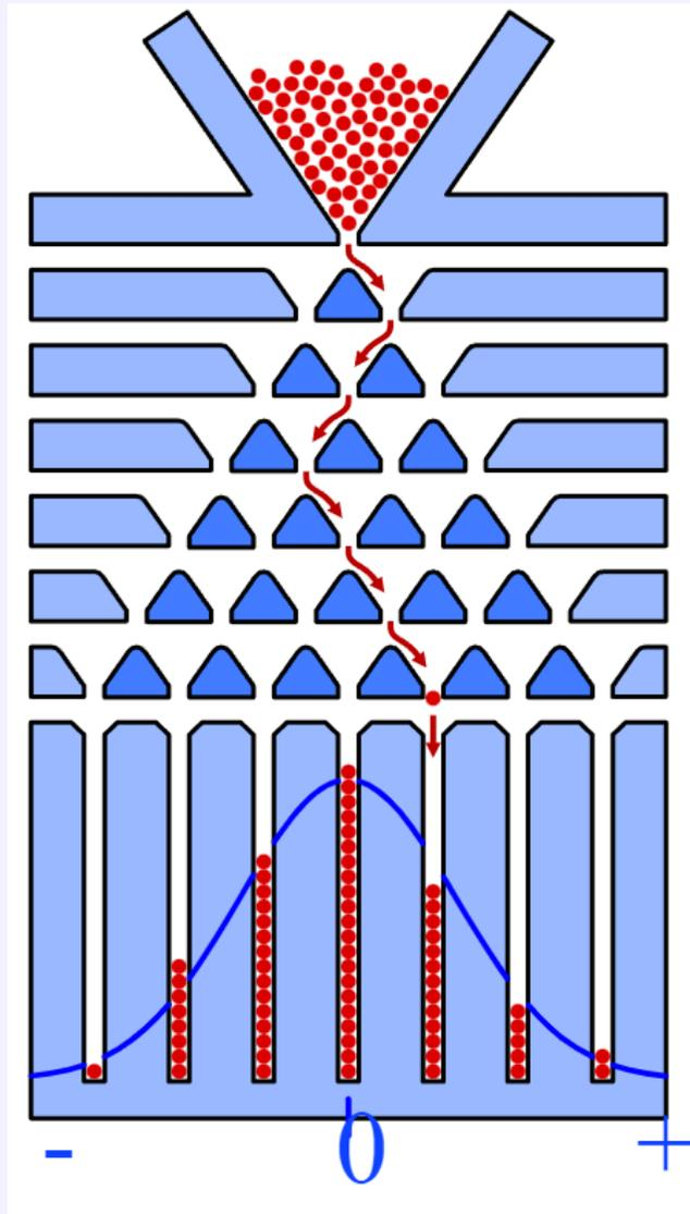
**Доска Гальтона** — устройство, изобретённое английским учёным Фрэнсисом Гальтоном (первый экземпляр изготовлен в 1873 году, затем устройство было описано Гальтоном в книге *Natural inheritance*, изданной в 1889 году) и предназначенное для демонстрации центральной предельной теоремы.
